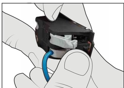
Führen Sie den Draht ohne Abisolieren in die Klemme ein und drücken Sie, bis ein Klicken zu hören ist. Und das ist alles.
