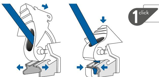
Der Kontakt ist messerförmig. Wenn Sie den Draht einführen und den Hebel drücken, schneiden oder trennen die Klingen die Isolierung, bis sie mit dem stromführenden Draht im Inneren in Kontakt kommen. So einfach ist es: kein Abisolieren, unzählige Vorteile.
